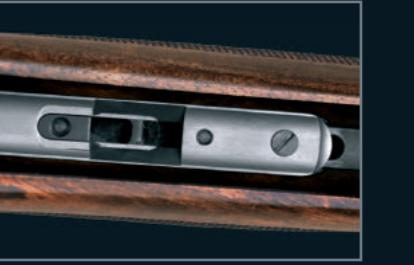
Le devant fer est pourvu d'une pièce interchangeable, en acier spécial, placé sur le point d'appui entre les tenons du canon et le devant fer. Ce qui permet un éventuel rattrapage de la poussée de longueur suite à une utilisation intensive de l'arme.
