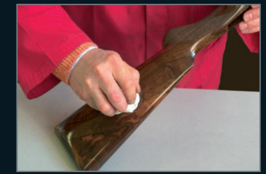
Les modèles réalisés pour la chasse, présentent une crosse très élégante dotée d'une poignée arrondie de type "Prince de Galles". Cette crosse demi-pistolet, réalisée à la main, se distingue nettement des crosses de même type réalisées en machine. D'un point de vue pratique, étant privée d'angle, la prise en main est beaucoup plus facile et confortable, même pour des mains de tailles diverses.
