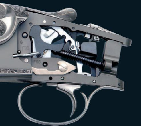
Les bascules, que ce soit en acier ou en ergal, sont monobloc, ce qui augmente la résistance de la matière durant les tirs.
