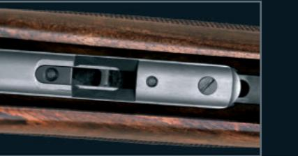
La croce è provvista di un inserto intercambiabile, in acciaio speciale, posto tra il tenone della canna e la croce stessa che consente di ripristinare facilmente eventuali lassità (tiraggio) dovute all'elevato uso dell'arma. I modelli Revenant ed Invictus IX sono provvisti della croce brevettata "Winged" che conserva tutte le funzioni meccaniche delle altre tipologie di croci e presenta due appendici laterali e simmetriche che consentono un ampio sviluppo dell'incisione su tutta la superficie.
