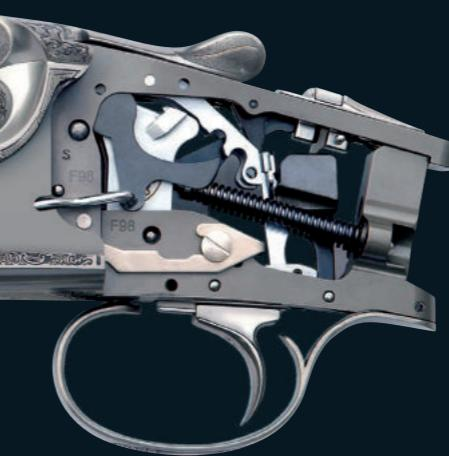
Le bascule, sia quelle in acciaio, sia in lega leggera, sono ricavate da un massello forgiato, il che significa che le fibre del materiale non subiscono alcun taglio d'utensile, a tutto vantaggio della resistenza del materiale stesso per l'assorbimento dell'esplosione dei colpi. Tutte le bascule al NiCrMo subiscono un procedimento di cementazione e tempera che garantisce una flessibilità ottimale al cuore del prodotto lasciando la superficie molto dura.
