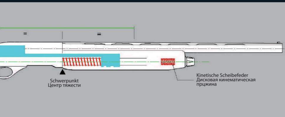
auch den stärksten Rückstoß zu dämpfen. Der Auszieher ist mobil, so dass die optimale Stellung zum Ausziehen jeglicher Munition gefunden werden kann.
