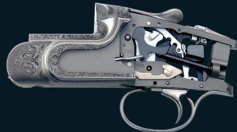
Herzstück unserer Flinten ist das aus einem Stück geschmiedete Gehäuse. Somit werden die entstehenden Kräfte optimal aufgenommen. Alle NiCrMo-Baskülen werden mit einem speziellen Härteverfahren bearbeitet. Dieses Verfahren garantiert die notwendige Zähigkeit des Werkstoffes und die entsprechende Verschleißfestigkeit Ihrer Waffe.
