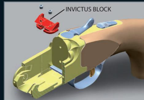
die INVICTUS CAM ersetzt hat, erlaubt das Projekt auch die Wiederinstandsetzung der Sperrung des unten-seitlichen Hakens des Laufes zusammen mit dem Ersatz des INVICTUS BLOCK, so dass das Gewehr auf den Status "WIE NEU" zurückgesetzt werden kann.
