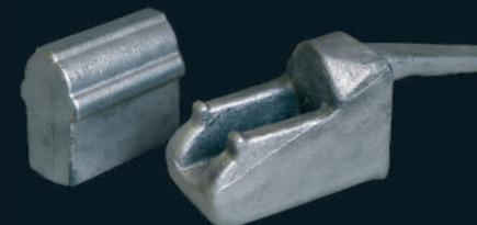
Kolodki rужей (ствольные коробки) изготавливаются как из стали, так и из легкого сплава методом горячей ковка металлургии, что придает им особую стойкость материала. Все легкоплавные колodки делаются из NiCrMo (никель-хром-молибденового) сплава, подвергаются цементации и закалке, что придает им высокую вязкость внутри, но при этом очень твердую поверхность снаружи.
