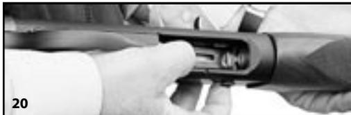
Drücken Sie den Hebel nach unten, der die Patronen in dem Magazinrohr hält (Bild 21). Die Patrone wird dann leicht aus dem Magazinrohr herauskommen. Halten Sie den Zubringer nach unten und wiederholen Sie den Vorgang, bis das Magazin leer ist.
