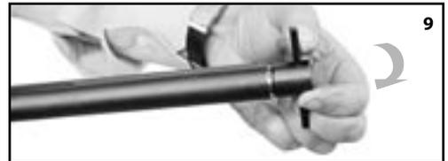
Man sollte darauf achten, dass der Schlüssel in den 6 breiten Knöcheln in der Chokebohrung steckt. Halten Sie das Gewehr fest und drehen Sie die Chokebohrung gegen den Uhrzeigersinn, bis sie vom Lauf entnommen werden kann.
