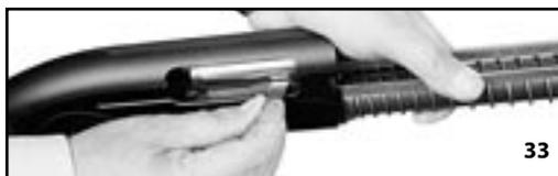
**e)** Vergewissern Sie sich, dass der Verschluss verriegelt ist. Setzen Sie den Stoßzylinder und die Inertialfeder wieder ein. Halten Sie den Verschluss nach vorne gezogen (Bild 4) und montieren Sie den Lauf. Stecken Sie den Vorderschaft auf das Magazinrohr (Bild 5) und schrauben Sie die Vorderschaftskappe fest an (Bild 6).
