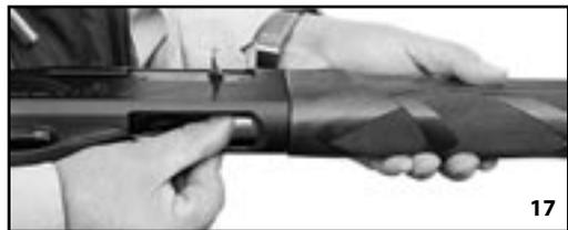
Schieben Sie die Sicherung auf OFF mit dem Zeigefinger der Hand, mit der Sie schießen (Bild 18). Siehe Abschnitt "Sicherheitsmerkmale". Mit geladenem Gewehr und Sicherung auf OFF ist das Gewehr schussbereit.
