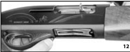
**c)** Stecken Sie durch die Auswurföffnung eine Patrone mit dem Rand nach vorne in die Basküle (Bild 13). Um die Patrone in die Kammer einzustecken, zielen Sie auf eine sichere Zielrichtung und drücken Sie auf den Knopf, der sich auf der linken Seite der Basküle befindet. Der Verschluss schließt sich, so dass die Patrone in die Kammer kommt (Bild 14).
