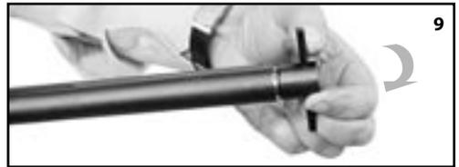
Insertar la llave en las 6 muescas anchas del choke. Sujetar firmemente el arma y desenroscar el choke en sentido contrario a las agujas del reloj hasta que pueda extraerse del cañón.
