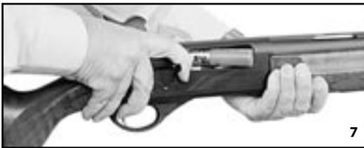
Para impedir que el cartucho se caiga al suelo es necesario recogerlo cuando sale por la ventana de expulsión. Deslizando el cerrojo lentamente hacia atrás el cartucho expulsado, sale por la ventana de expulsión en modo controlado y fácil. Esto impide que el cartucho se caiga al suelo donde podría encontrar algo que podría hacerlo detonar.
