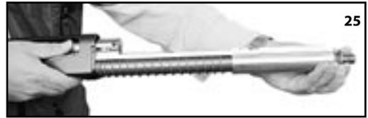
Sacar el grupo cerrojo – carro de armamento (foto 25) – muelle recuperador y muelle inercial. El obturador, el carro de armado, el muelle de recuperación, y el muelle inercial, se sacan extrayendolos del tubo del cargador.
