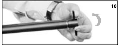
(foto 11) Choke que se instala en el cañón.
