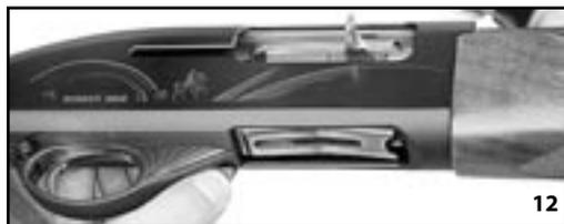
**c)** Poner un cartucho en la recámara a través de la ventana de expulsión con el reborde hacia adelante (foto 13).
