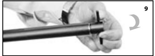
Faites bien attention : la clef doit rentrer dans les 6 larges crans sur le choke, tenez l'arme bien fermement et dévissez le choke dans le sens inverse aux aiguilles d'une montre jusqu'au moment où vous pourrez l'enlever du canon.
