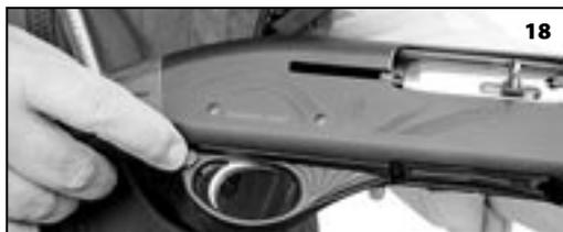
**b)** Tourner le fusil comme cela a été indiqué précédemment. Pousser l'élévateur avec l'extrémité ourlée de la cartouche jusqu'à avoir accès à la calotte du ressort du réservoir. Pousser la cartouche en avant à l'aide du pouce jusqu'à ce que le levier d'alimentation se déclenche derrière elle (voir photo 16) Répéter l'opération jusqu'à ce que le réservoir soit complètement chargé.
